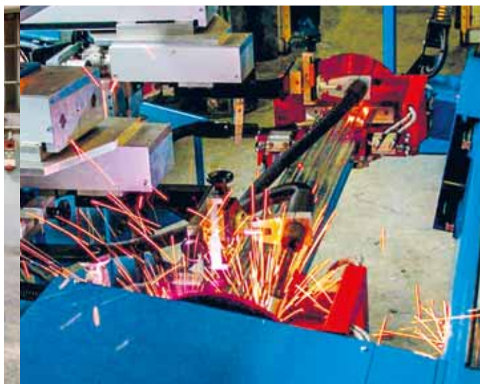
Impianti saldatura ammortizzatori. Installations for welding of shock absorbers
