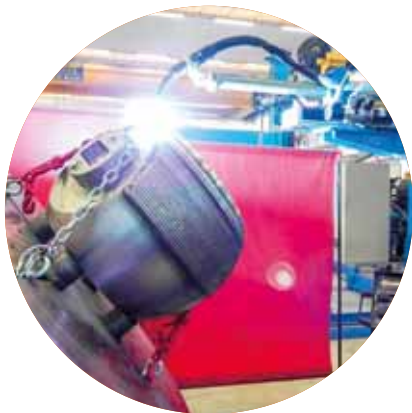
■ Impianti con riporto MIG e TIG. Installations for hard-facing with MIG/MAG or TIG process.
