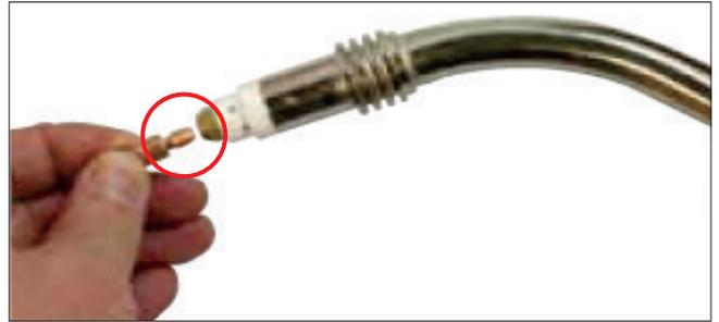
15. Drücken und halten Sie die manuelle Drahttaste, um den Draht zum Brennerhals zu schieben, lassen Sie die manuelle Drahttaste los, wenn der Draht aus dem Brennerhals austritt.
