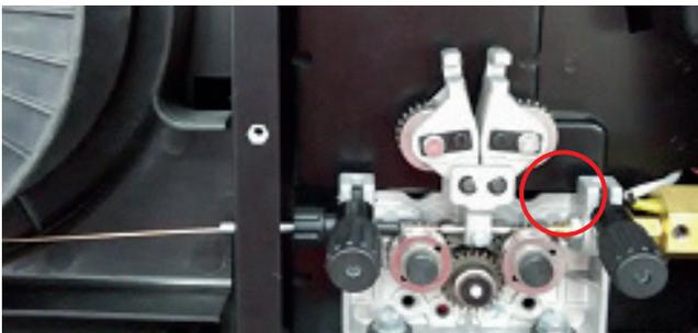
13. Richten Sie den Draht in der Nut der Antriebsrolle aus, schließen Sie die obere Rolle und stellen Sie sicher, dass sich der Draht in der Nut der unteren Antriebsrolle befindet, und verriegeln Sie den Druckarm in seiner Position. Üben Sie mittleren Druck auf die Antriebsrolle aus.
