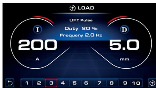
Nella schermata CARICA, premere il tasto sinistro per tornare indietro, ruotare il pulsante per selezionare e visualizzare il gruppo di parametri salvati, premere il tasto destro per accedere all'interfaccia di saldatura.
