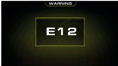
La schermata riportata sopra viene mostrata quando la saldatrice non riceve gas o la pressione dell'aria è bassa.
