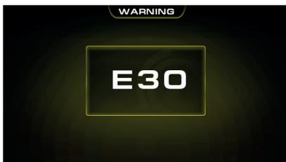
La schermata riportata sopra viene mostrata quando è rilevato un problema con il sistema della torcia o dell'alimentazione d'aria e il prodotto del taglio. Potrebbe anche derivare dal fatto che il cappuccio schermato della torcia non è installato o danneggiato o che manchino i materiali di consumo per la torcia o che la pressione dell'aria che alimenta la torcia sia insufficiente.
