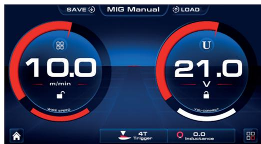
**NB:** i parametri di saldatura, ad esempio avvio a caldo/arc force/duty e frequenza, sono preimpostati in fabbrica: Se la saldatura risulta difficoltosa, andare al 3 passaggio per regolarla.
