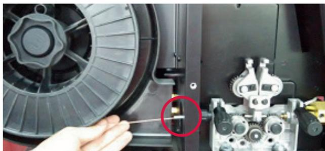
6. Far scorrere con attenzione il filo sopra il rullo di azionamento nel tubo di guida della presa e farlo avanzare per circa 150 mm nell'apposito connettore della torcia. Verificare che la dimensione del rullo di azionamento sia compatibile con il diametro del filo; sostituire il rullo se necessario.
