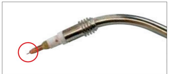
17. Montare l'ugello del gas sulla testa della torcia.
