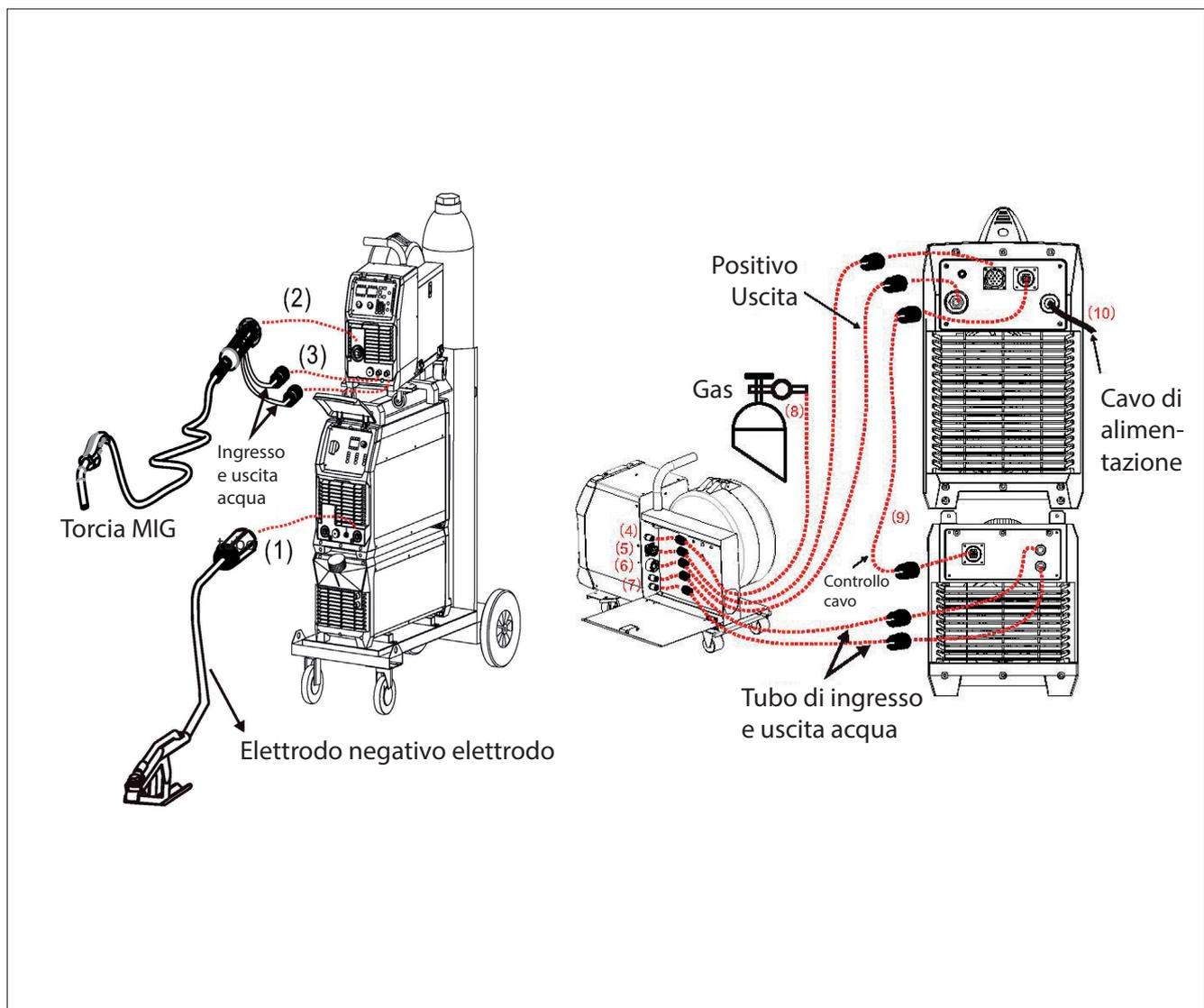
**NOTA: Modalità di raffreddamento ad aria senza dispositivo di raffreddamento; il tubo dell'acqua non è necessario se si utilizza la modalità di raffreddamento ad aria.**
