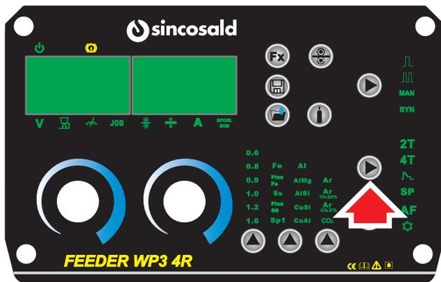
20. Selezionare il procedimento di saldatura e il programma desiderato con i tasti filo / materiale / gas.
