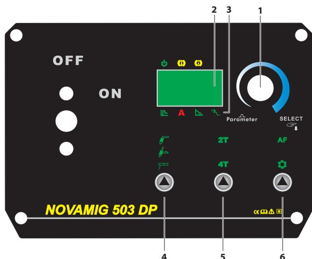
1. Impostazione Corrente di saldatura/Tempo rampa di discesa
