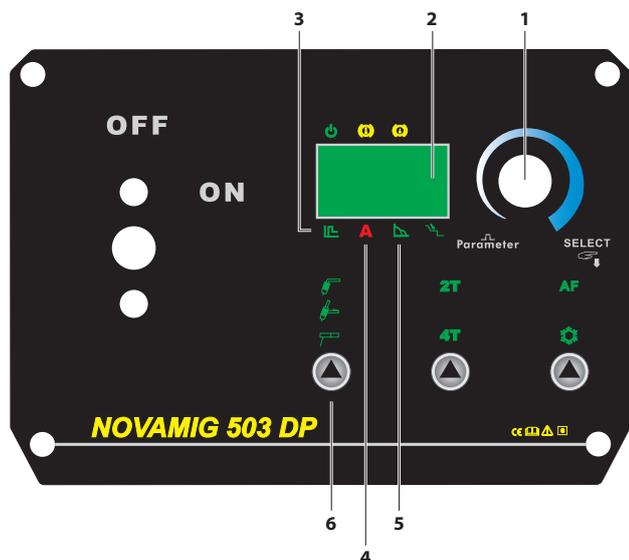
1. Impostazione Corrente di saldatura /Arc force / Avvio a caldo
