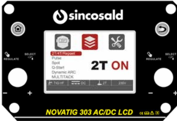
C. **Interfaccia di regolazione di sistema:** è possibile selezionare e impostare un parametro di sistema e il valore corrispondente ruotando la manopola (F) e la manopola (G) dell'interfaccia, come mostrato di seguito:
