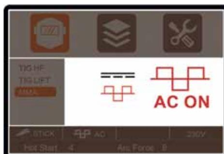
B. **Interfaccia di regolazione parametri di saldatura:** è possibile selezionare e impostare un parametro di saldatura e il valore corrispondente ruotando la manopola (F) e la manopola (G) dell'interfaccia.
