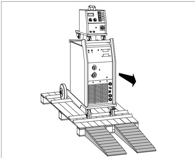
Nel caso sia presente la sola saldatrice questa deve essere movimentata tramite la comoda maniglia presente nella parte superiore della saldatrice stessa.
