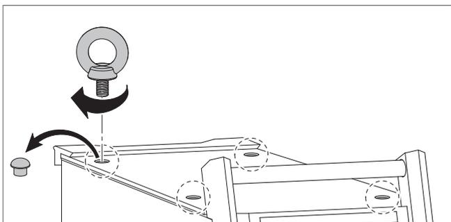
**Non sollevare la macchina dalle maniglie del FEEDER o del generatore.**
