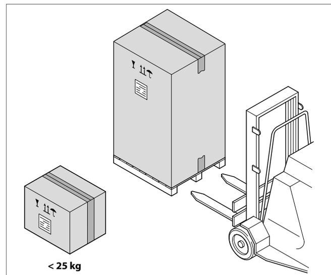
Für die Verstellungen innerhalb des Werks kann das Gerät auch mit einem Laufkran transportiert werden, vorausgesetzt, es ist mit Gurten oder Seilen gesichert, deren Festigkeitswerte seinem Gewicht entsprechen. Wenn die Lieferung nur das Schweißgerät umfasst, das im Allgemeinen weniger als 25 kg wiegt, besteht die Verpackung aus einem Karton ohne Hebepalette. Dieser kann leicht von zwei Personen angehoben und zum Einsatzort getragen werden.
