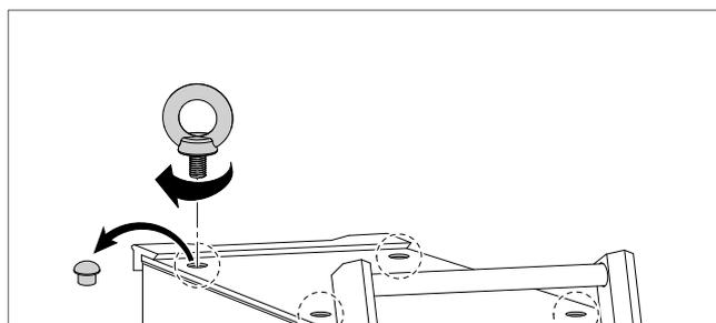
**Das Gerät nicht an den Griffen von FEEDER oder Generator anheben.**
